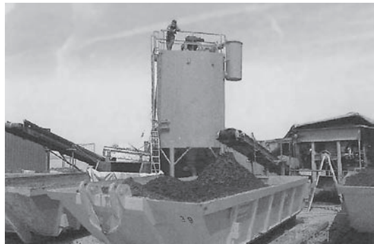
Die entwässerte Sedimentfracht wird über Förderbänder in Mulden geleitet [Diethelm].
